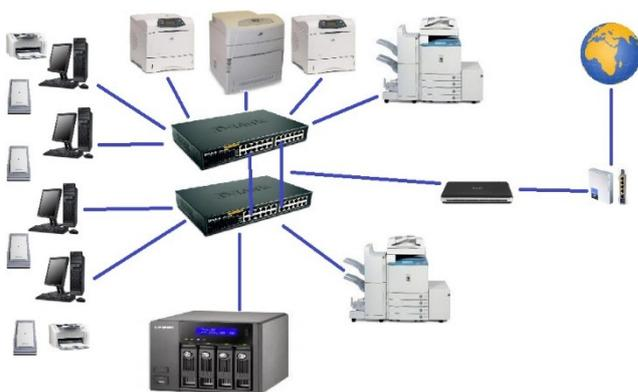
radial de cableado RJ45, a través de equipos de gestión de tráfico inteligente y velocidades de red de 1Gb, a los cuales se conectan los servidores del CES (servidor de aplicaciones, de ficheros e impresión, DHCP, servidor de correo, firewall, intranet, software de gestión bibliotecaria y Microsoft SharePoint para uso interno), que a su vez están conectados a varias líneas de cable de
